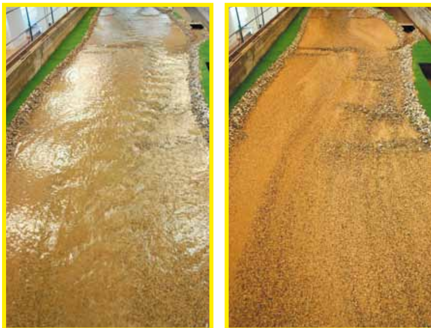
Obr. 10: Fyzikální hydraulický model zařízení pro ovlivnění splaveninového režimu v prostoru pod hrází VD Nové Heřminovy. Laboratoř vodohospodářského výzkumu VUT v Brně, 2010. Modelování dna proudící vodou (a) a vyhodnocení morfologie dna (b)
