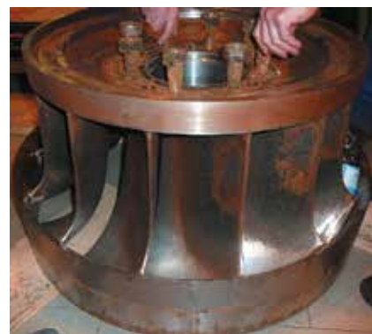
Oběžné kolo vertikální Francisovy turbíny je zhruba po 18 letech provozu bez poškození
