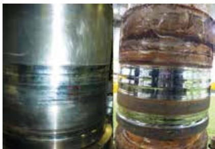
Poškození pouzdra ucpávky v roce 2010 a 2015 na turbíně TG1
